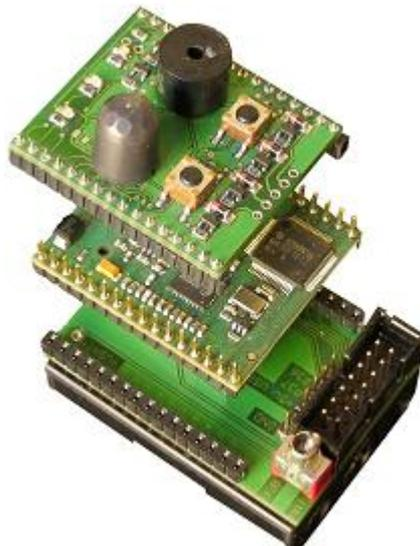
Abbildung 3.1.: MSB-430 mit optionalem Sensorboard MSB-430S und Trägerboard
